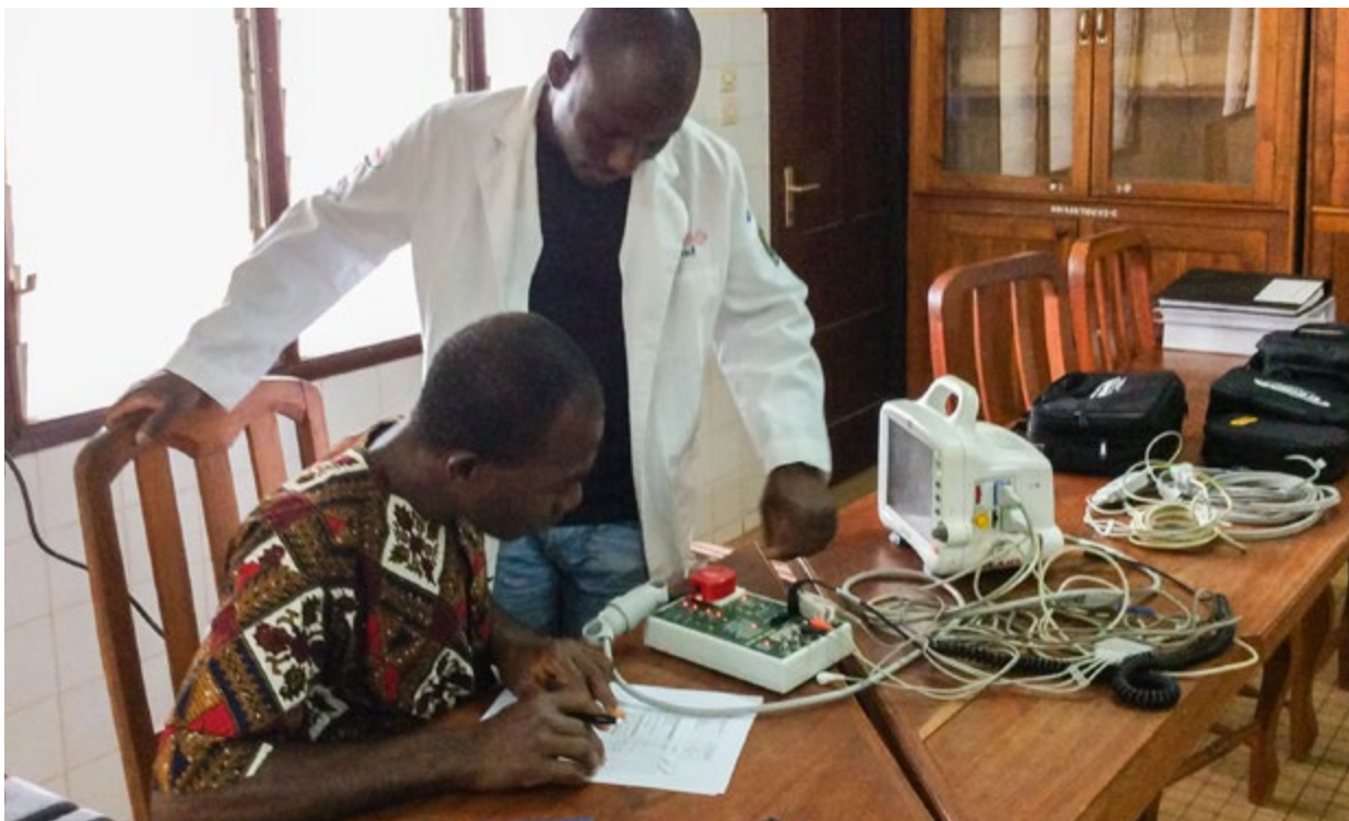
Le facilitateur Emmanuel Essah (Bénin), formant un participant de Lokossa à pratiquer des tests de sécurité électrique sur du matériel. | Photo: BEE170301_BIOMEDICAL_TRAINING_ESSAH_MS001
