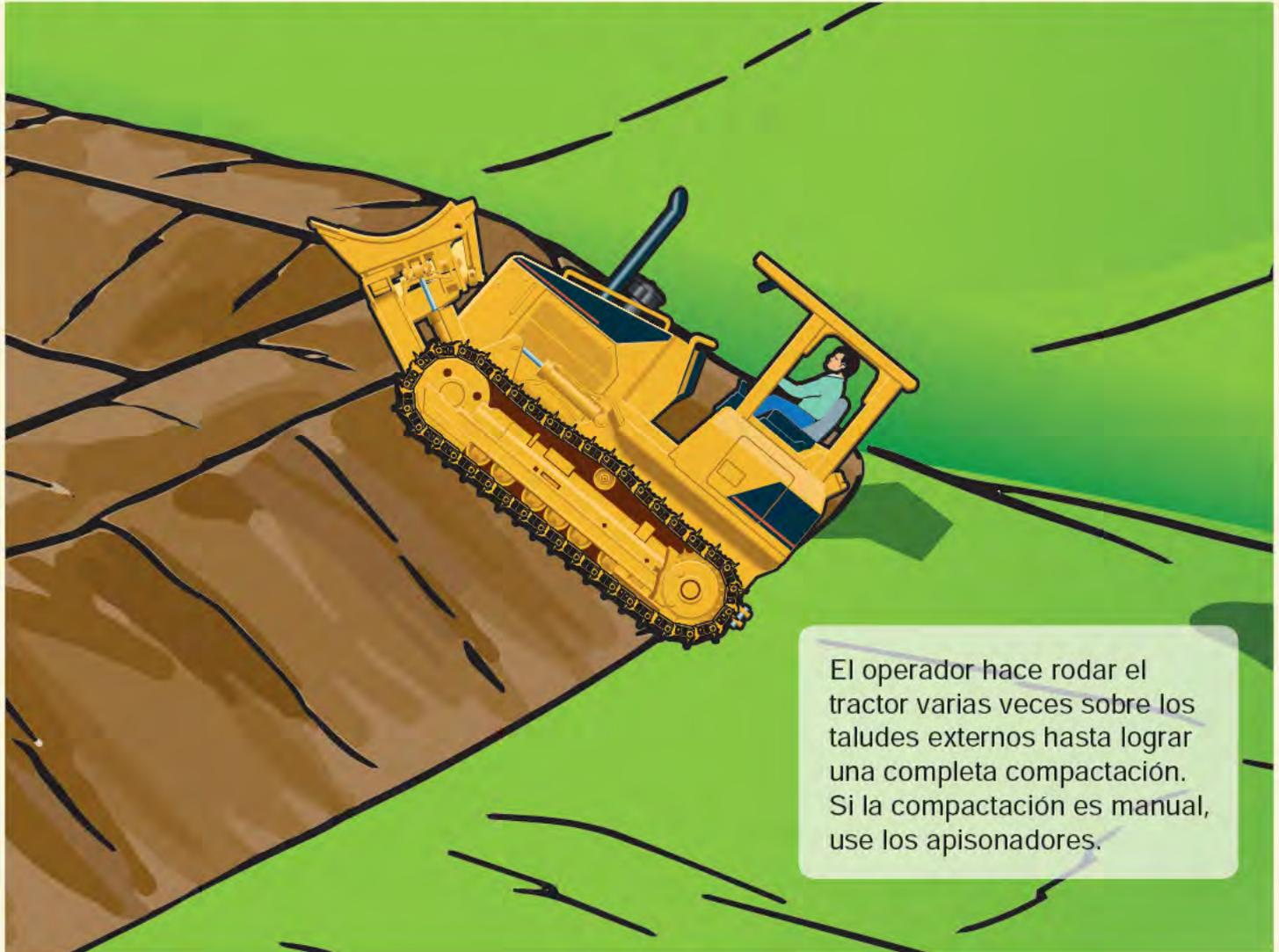
El operador hace rodar el tractor varias veces sobre los taludes externos hasta lograr una completa compactación. Si la compactación es manual, use los apisonadores.
