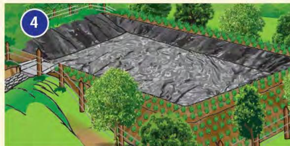
Si el reservorio ha sido bien compactado e impermeabilizado con lodo arcilloso, las pérdidas por infiltración se reducen o se eliminan por completo.
