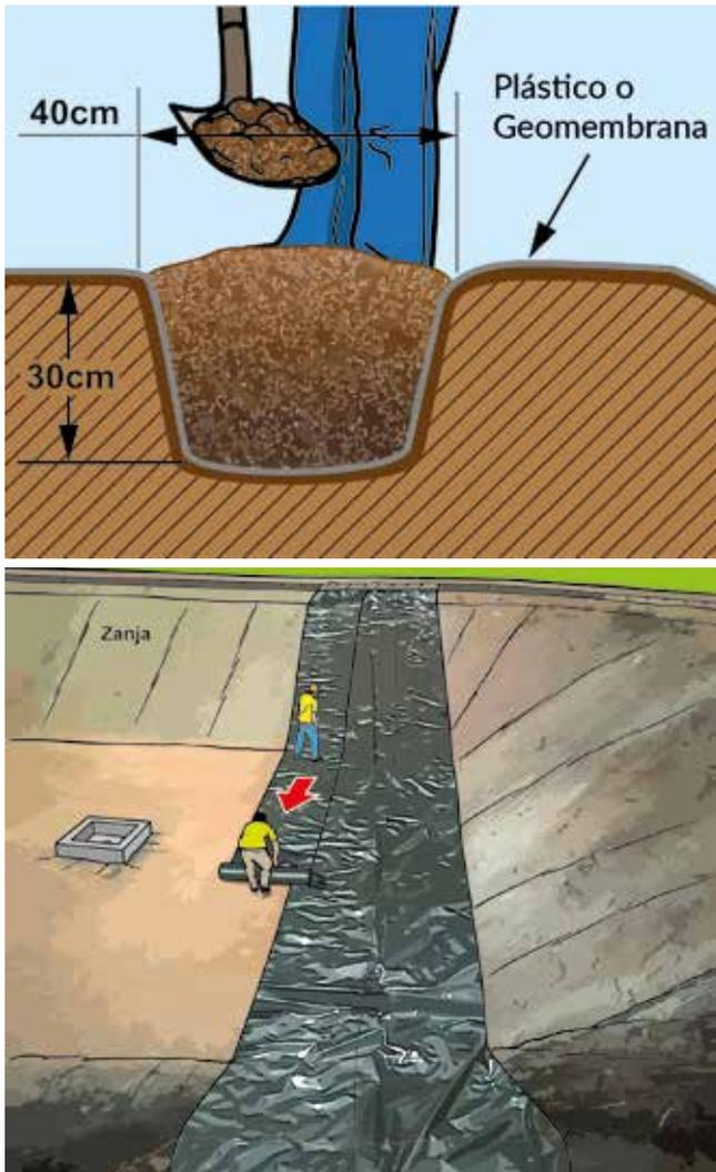
**Figura 3.** Colocación de plástico o geomembrana.
