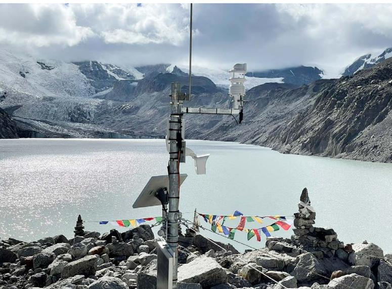
Abbildung 8: Installation einer Überwachungsstation für ein Frühwarnsystem für Gletscherseeausbrüche in Sikkim, Indien.
