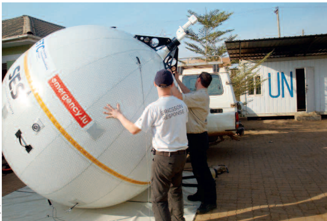
Un sistema mobile di comunicazione satellitare che si avvale di un pallone aerostatico – nella foto, in Sud Sudan nel 2012 – permette la connessione a internet anche in situazioni di crisi.
