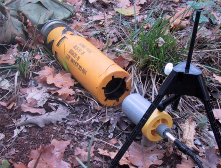
Destruction des munitions non explosées : Grâce au système SM-EOD développé en Suisse, les munitions non explosées peuvent être détruites sans contact. (c) DDPS
